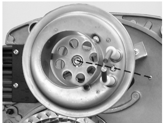
Abb. 38: Mischsystempositionierung und Ausrichtung Zündelectrode
